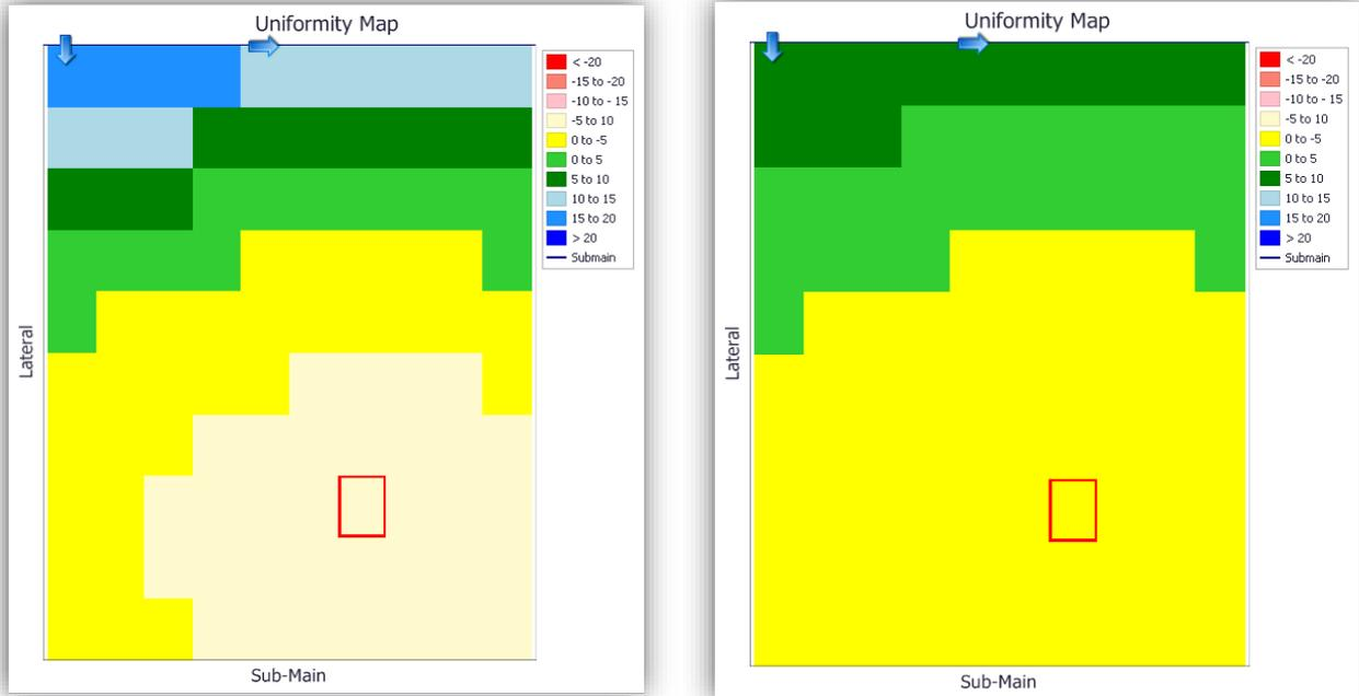
**Ilustración 4 - Diagrama de Uniformidad con el uso de dos diferentes cintas de riego. Para el diagrama de la izquierda se utilizó Aqua-Traxx Classic, cinta de riego por goteo; y en el de la derecha Aqua-Traxx PC, la cinta de riego autocompensada.**
