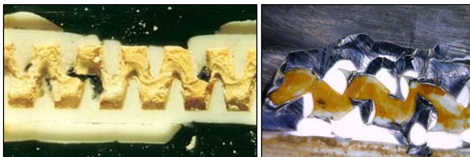
Figura 13. Casos extremos de taponamiento con productos químicos
