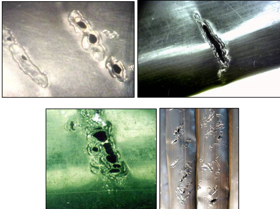
Figura 21. Daño debido al “efecto lupa”. Nótese los bordes redondeados.
