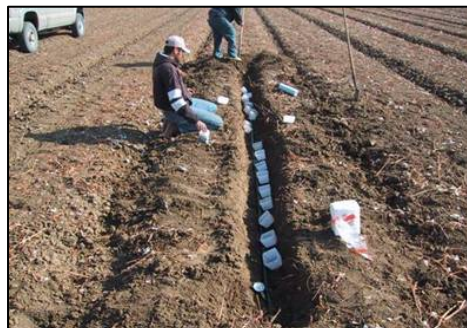
Figura 3. Recipientes de plástico alineados en preparación para la medición de flujo de emisores individuales. Nótese el medidor de presión en primer plano.
