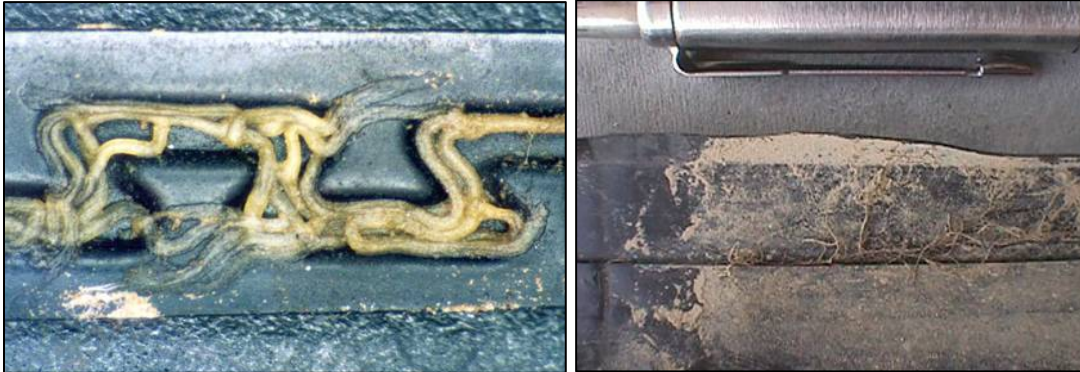
Figura 9. Ejemplos de intusión de raíces
