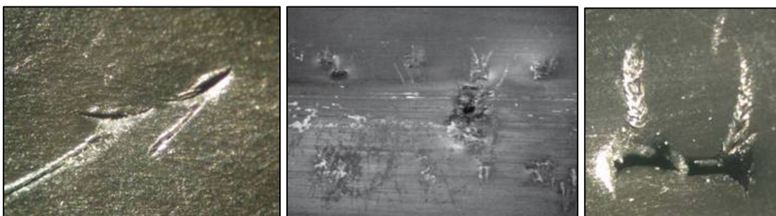
Figura 18. Ejemplos de daño por roedores, generalmente con típicas marcas de rasguños
