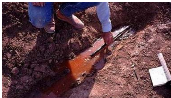
Figura 14. Precipitado químico extraído por lavado de la cinta. El compuesto químico no identificado es supuestamente un fertilizante. Fue inyectado aguas abajo de los filtros y tapó un sistema completo de riego.
