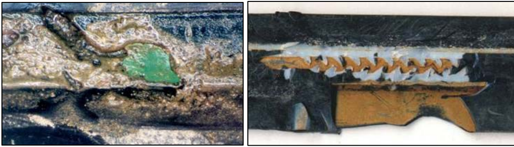
Figura 10. Casos extremos de baba bacteriana unida a limo y arcilla (l) y depósitos de hierro (r) que obstruyen un emisor.
