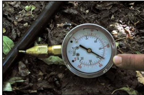
Figura 1. Medidor de presión en baño de aceite de 30 psi con tubo pitot insertado en la cinta
