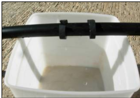
Figura 2. Tramos de manguera de radiador colocados sobre la cinta para medir flujo, uno a cada lado del emisor. Nótese el recipiente cuadrado para verter líquido fácilmente en una probeta sin derramarlo.
