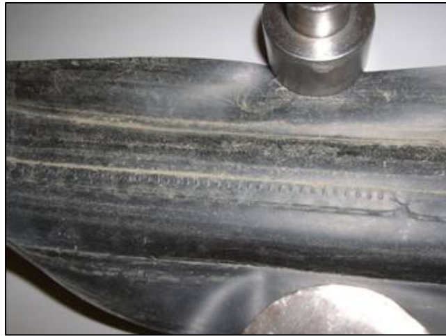
Figura 11. Taponamiento de entradas a las vías del emisor
