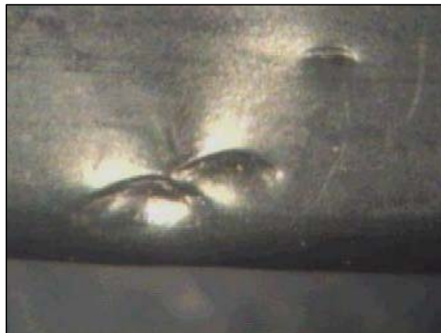
Figura 20. Daño por aves en cinta de 15 mils. El agujero es típicamente algo cóncavo hacia adentro
